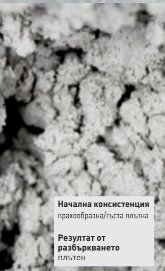
Начална консистенция прахообразна/гъста плътна Резултат от разбъркването гладък гъст материал
