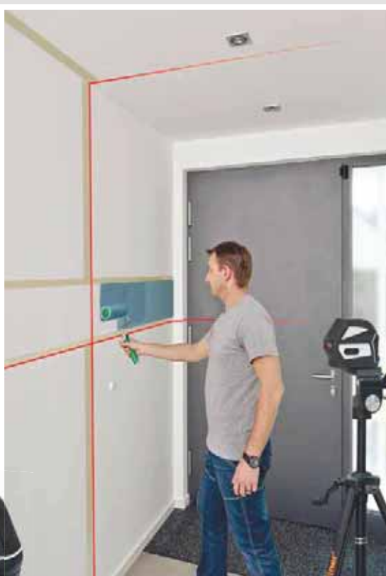
Магнитната стойка, проектирана като адаптер за статив, осигурява видим точков отвес при AutoCross-Laser 2 XP и XPG.
