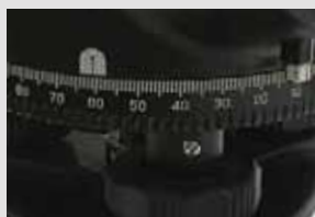
Хоризонтален кръг с безкраен въртящ се нониус за прецизно позициониране.
